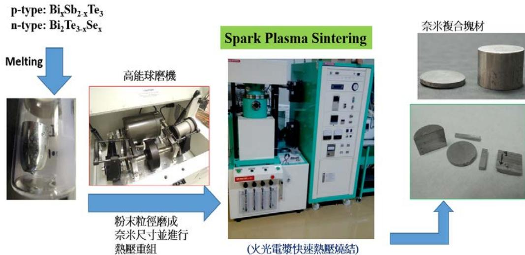
圖九、使用火花電漿燒結技術製備奈米結構塊材的流程。
