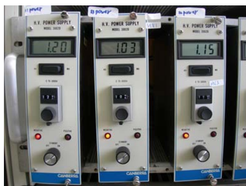
圖十二 光電倍增管接上的高壓
