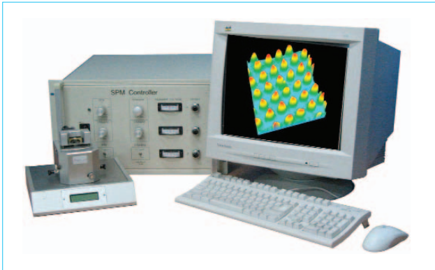
圖 4. A-100 原子力顯微儀。
