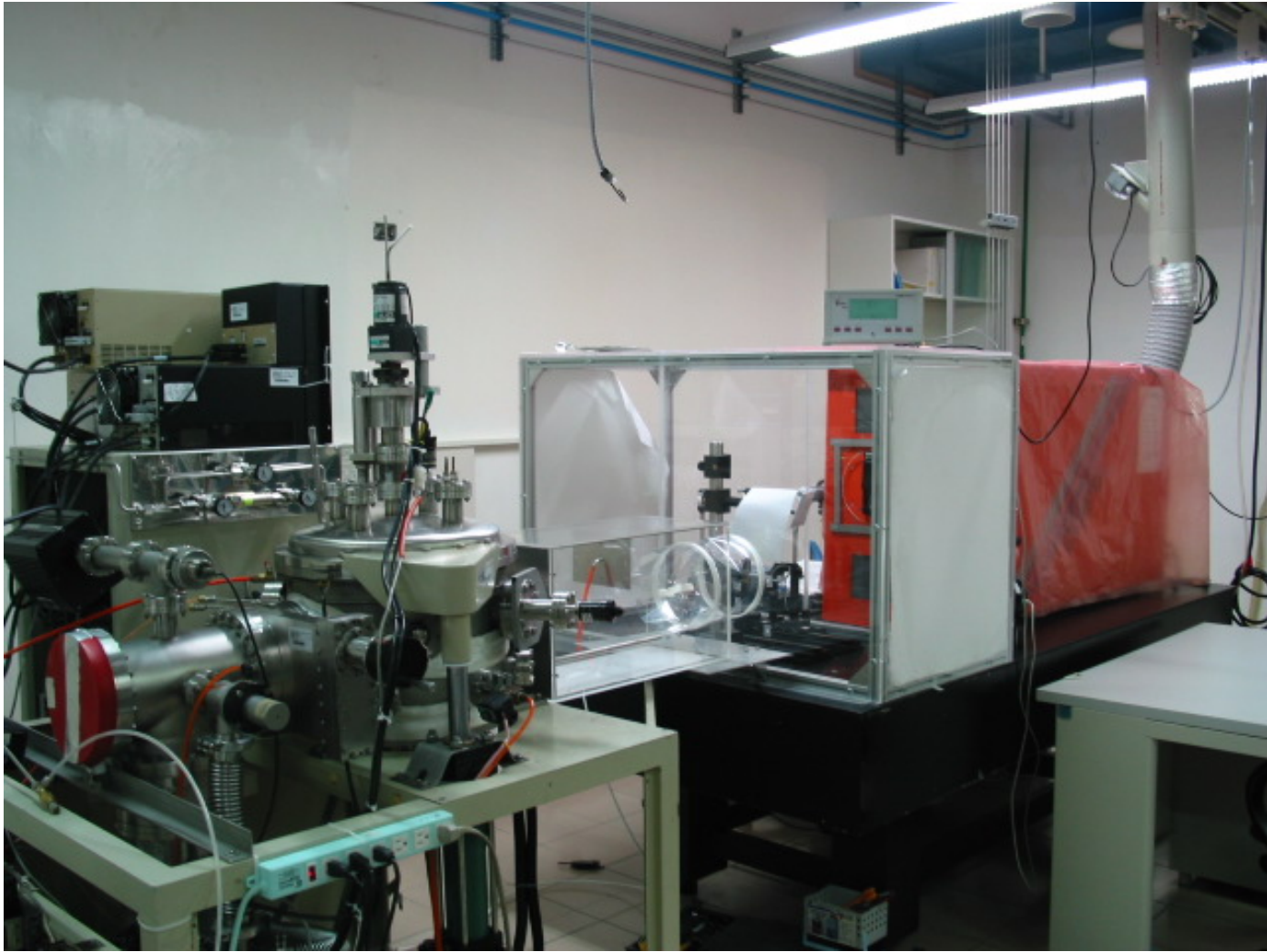
準分子雷射濺鍍 ( Excimer Laser Ablation 簡稱 ELA ) (建於2003/3) 及奈米成長真空系統 (建於1993/1)。
