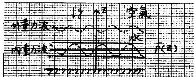
圖一、在層流中，因密度分層而造成之重力波
